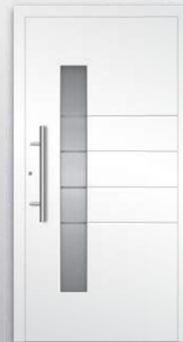
RK340 MODERN (einseitig flügelüberdeckend) • Stoßgriff: ES 30.600 • vorne: VSG • Mitte: WSG mattiert mit klarem Streifen • hinten: Float beschichtet • Nut nur außen • Oberfläche: Ral 9016 Verkehrsweiß
