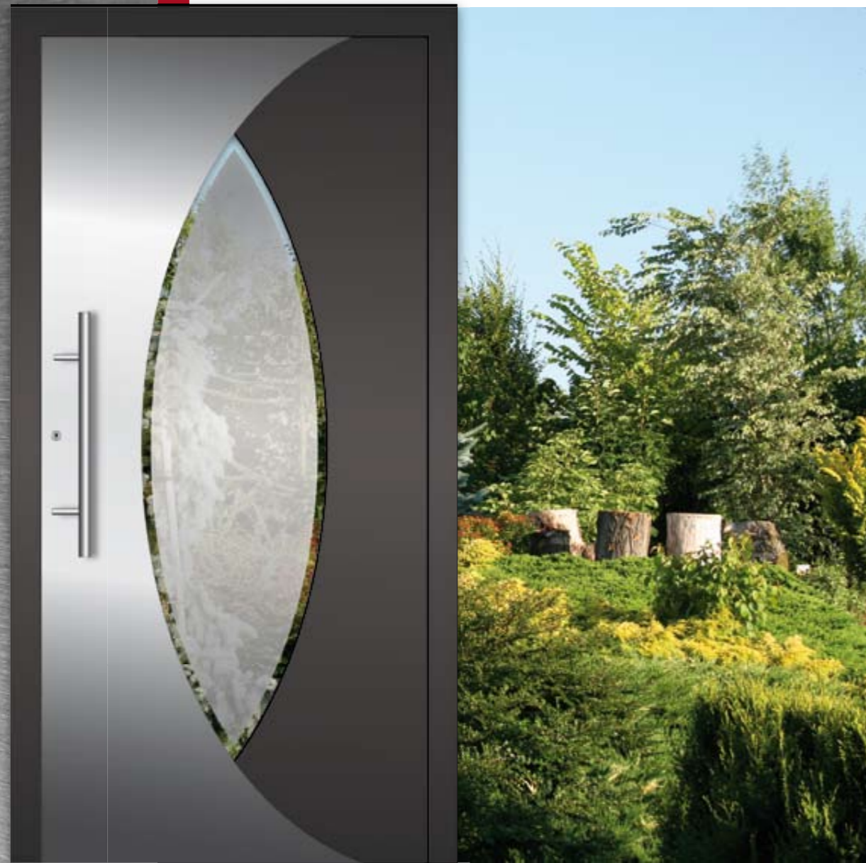
RK470 MODERN (einseitig flügelüberdeckend) • Stoßgriff: ES 30.600 • vorne: VSG • Mitte: WSG mattiert mit klarem Rand • hinten: Float beschichtet • Inox Applikation nur außen • Oberfläche: Ral 7016 Anthrazitgrau matt
