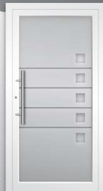
RK630 STANDARD • Stoßgriff: ES 30.600 • vorne: VSG • Mitte: WSG mattiert mit klaren Streifen und Motiven • hinten: Float beschichtet • Oberfläche: Ral 9016 Verkehrsweiß
