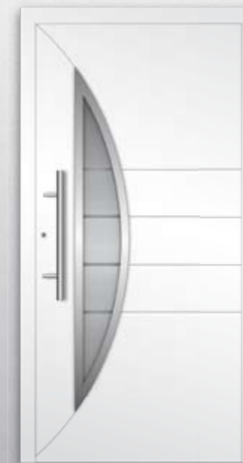
RK220 MODERN (einseitig flügelüberdeckend) • Stoßgriff: ES 30.600 • vorne: VSG • Mitte: WSG mattiert mit klarem Rand • hinten: Float beschichtet • Inox Applikation und Nut nur außen • Oberfläche: Ral 9016 Verkehrsweiß
