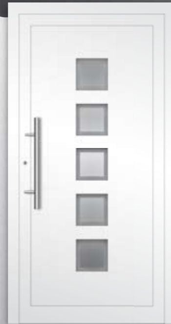
RK440 STANDARD (Glasfalzeinsatz) • Stoßgriff: ES 30.600 • vorne: VSG • Mitte: WSG mattiert mit klarem Rand • hinten: Float beschichtet • Oberfläche: Ral 9016 Verkehrsweiß
