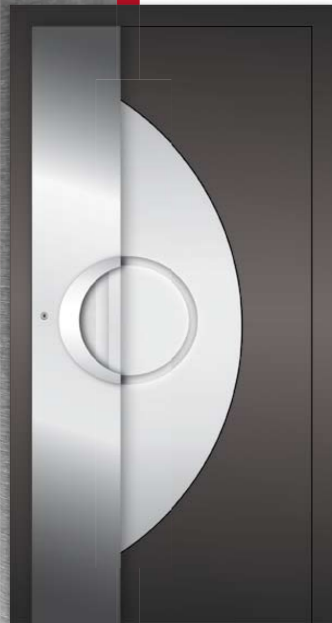
RK150 MODERN (einseitig flügelüberdeckend) • Stoßgriff: ES 150 • vorne: VSG • Mitte: WSG mattiert mit klaren Streifen • hinten: Float beschichtet • Inox Applikation nur außen • Oberfläche: Ral 7016 Anthrazitgrau matt
