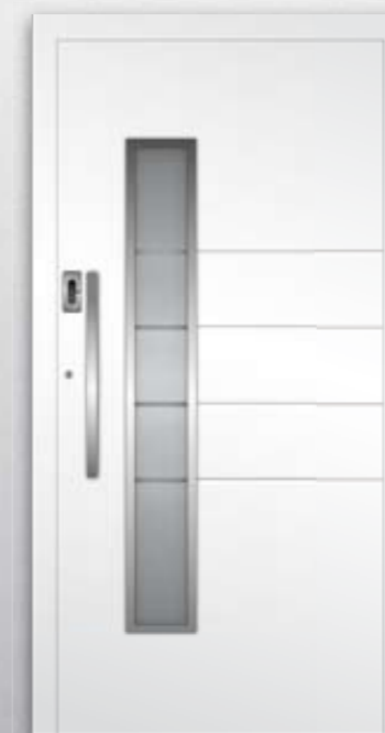
RK180 MODERN (einseitig flügelüberdeckend) • Stoßgriff: ES 60.600 • vorne: VSG • Mitte: WSG mattiert mit klaren Streifen • hinten: Float beschichtet • Inox Applikation und Nut nur außen • mit Fingerscanner • Oberfläche: Ral 9016 Verkehrsweiß
