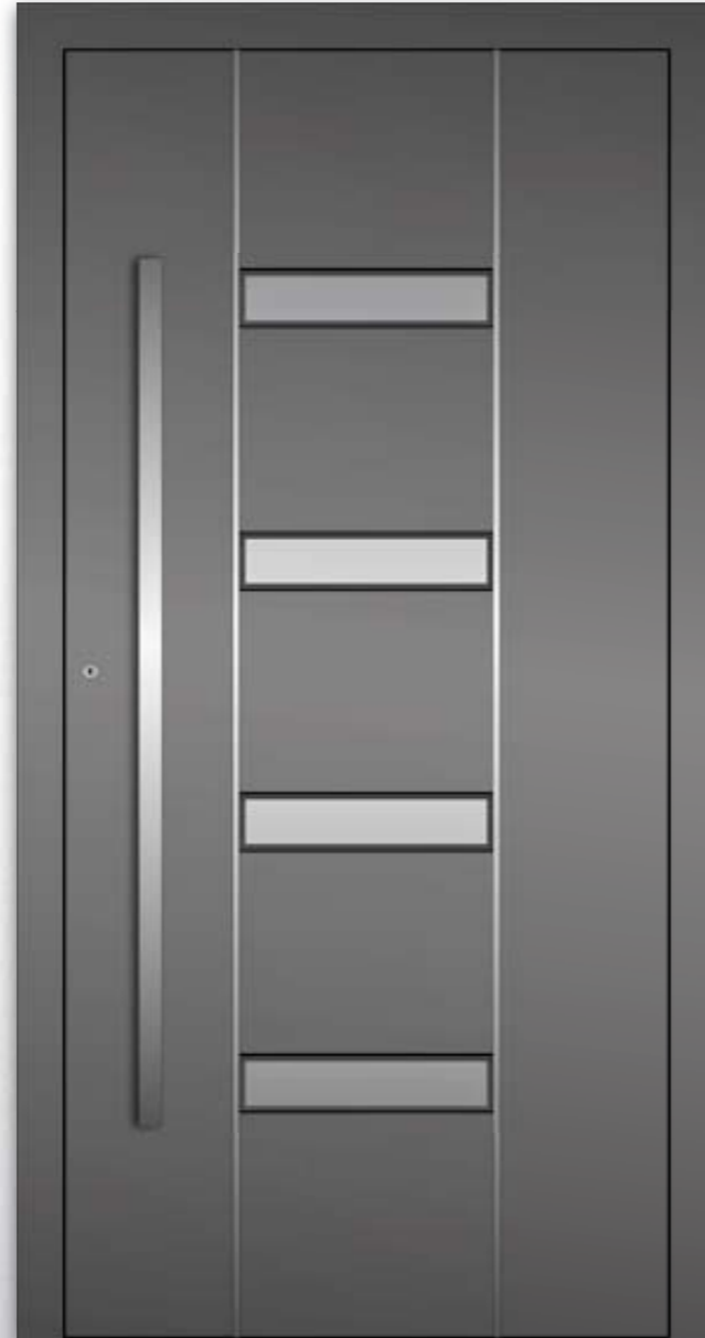
RK200 MODERN (einseitig flügelüberdeckend) • Stoßgriff: ES 60.1400 • vorne: VSG • Mitte: WSG mattiert mit klarem Rand • hinten: Float beschichtet • Inox Applikation und Nut nur außen • Oberfläche: Metallic Feinstruktur DB 703
